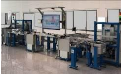
Bild 3: Transparenz durch intelligente Werkstückträger: Die Bediener erhalten wichtige Daten zum Betriebszustand der Anlage übersichtlich am Monitor.
