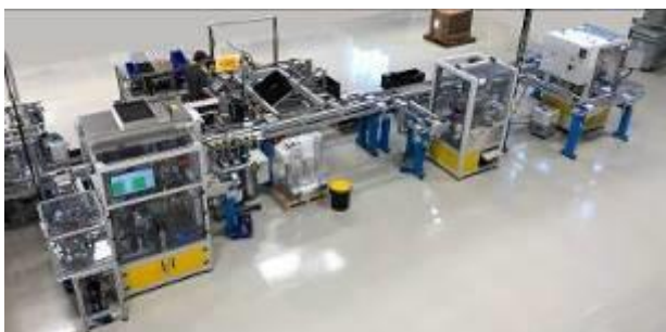
Bild 2: Werkstückträger-Transportsystem von STEIN im Einsatz bei SBS Drivetech Inc. im kanadischen Barrie. Das Unternehmen fertigt hauptsächlich Aktuatoren für die Automobilindustrie.
