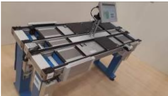
Bild 4: STEIN hat für seine Werkstückträger-Transportsysteme elektrische Stopper entwickelt, die den Aufwand für Hydraulik-Verschlauchungen vermeiden.
